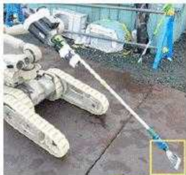
①床面溶融物の掻き取り Warrior+ヘラ (掻き取り調査と同じ)
