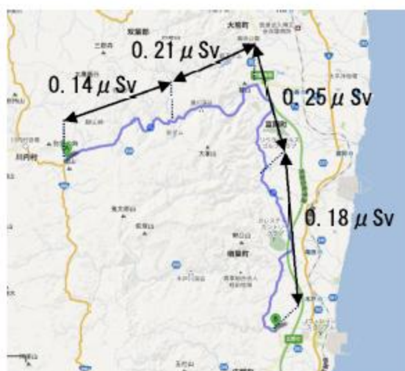
図 10 県道 36 号及び県道 35 号上の空間線量率 ( \mu\text{Sv/h} ) の分布及び運転手の外部被ばく線量 ( \mu\text{Sv} ) の試算結果
